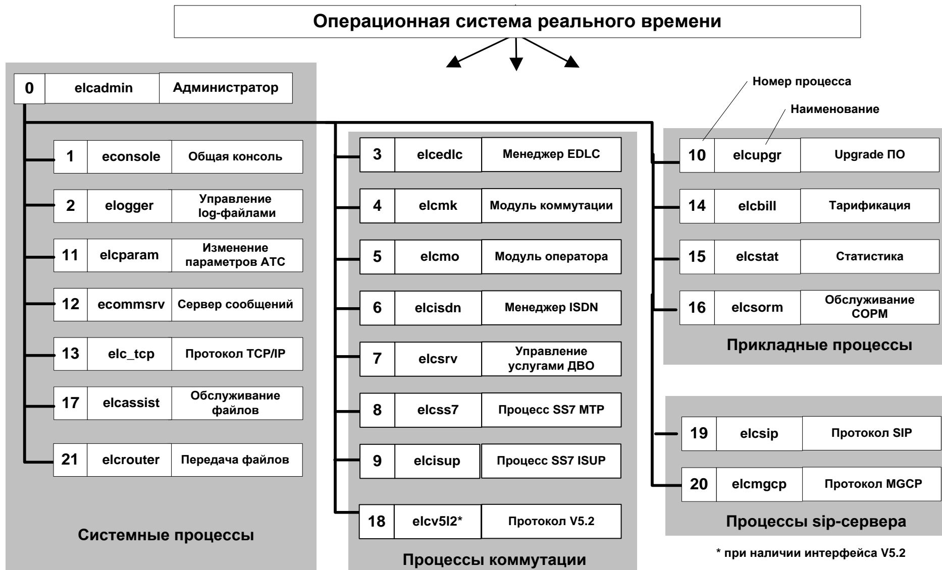
Рис.2.4. Структура ПО, функционирующего в ВМ (ОС РВ и набор процессов)
